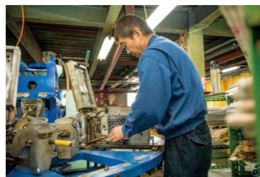
インナーの布と塩化ビニール樹脂を熱で一体的に成型
